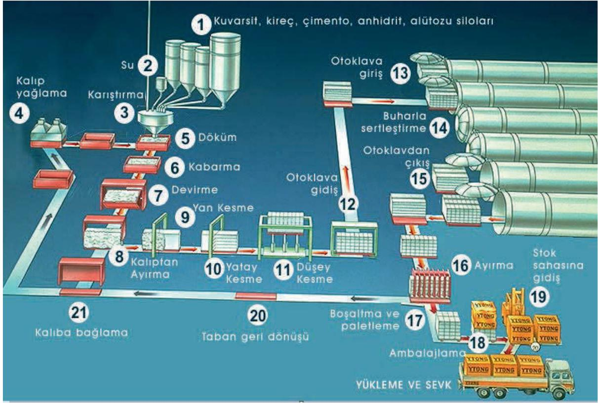
Şekil 1: Ytong Gazbeton Blok Üretimi Akış Şeması
